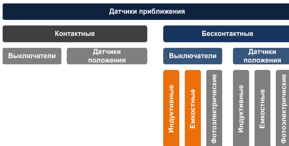
Рисунок 1 – Виды датчиков приближения
