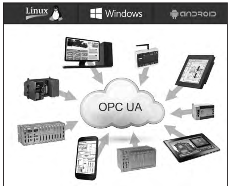
Рис. 1. Примеры поддерживаемых устройств для MasterSCADA 4D со стандартом OPC UA
