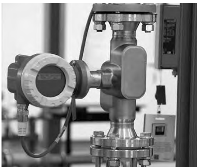
Рис. 1. Ультразвуковой расходомер Prosonic Flow 92F – первый в мире двухпроводный фланцевый ультразвуковой расходомер для измерения расхода жидкости
