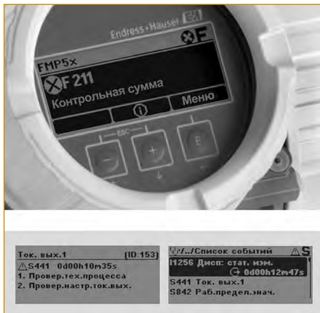
Рис. 3. Вид диагностических сообщений в соответствии с рекомендацией NAMUR NE 107, реализованных в новой унифицированной платформе двухпроводных приборов
