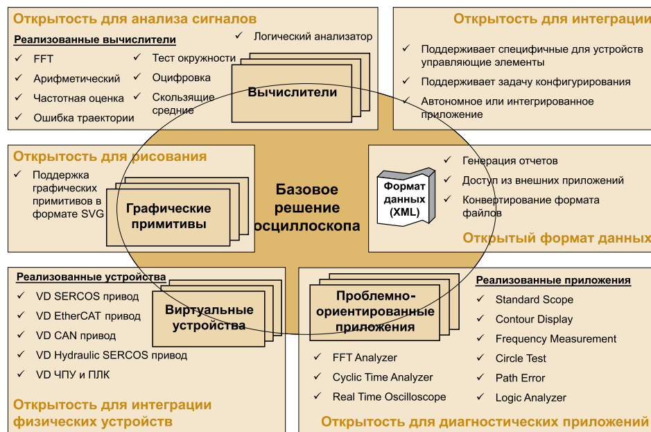
Рис. 2. Концепция реализации открытости ядра цифрового осциллографа
