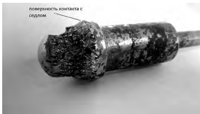
Повреждение плунжера кавитацией при регулировании близко к седлу
