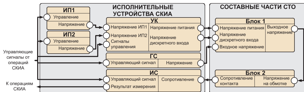
Рис.5. Агрегативная модель фрагмента системы SKIA – СТО
