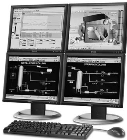
Рис. 5. Рабочая станция DeltaV
