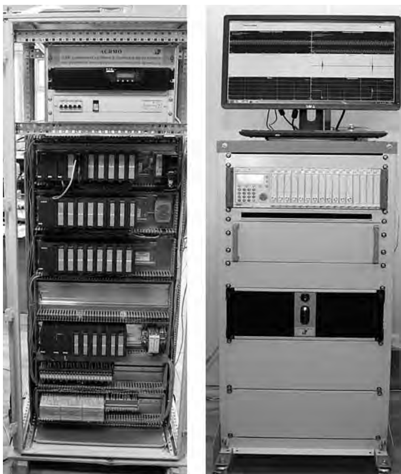
Рис. 6. Примеры АПК: управления силовым и тепловым нагружением (слева) и регистрации импульсных процессов (справа)
