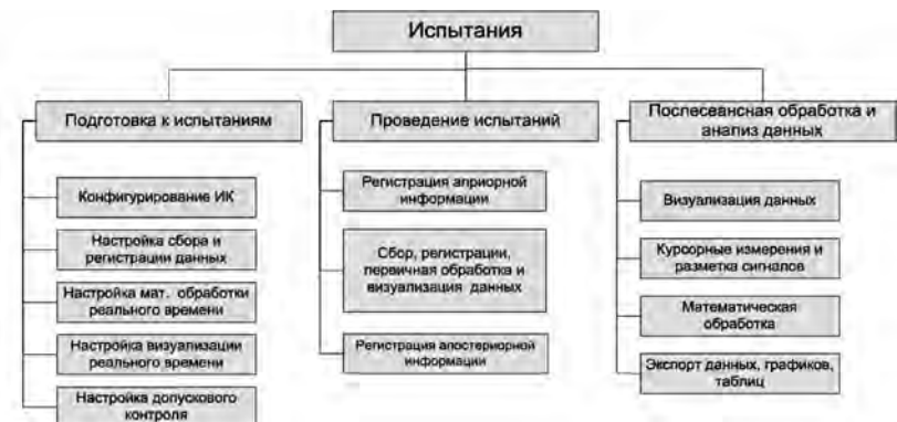
Рис. 3. ACTest - перенастраиваемые системы измерения на всех этапах экспериментальной отработки
