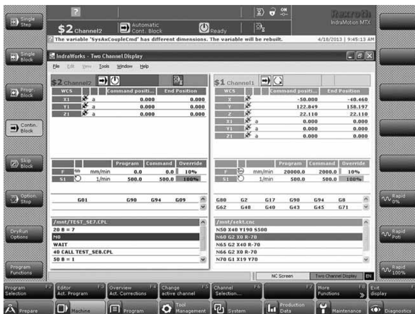
Рис. 1. Экран оператора для управления двух каналов системы ЧПУ MTX (Bosch Rexroth)
