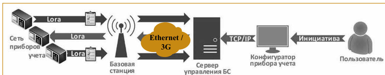
Рис. 2. Сбор данных в ручном режиме с прибора учета
