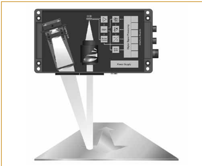
Рис. 7. Структура датчика VLM500A
