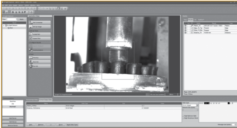
Рис. 11. Вид изделий на экструдере со стороны камеры технического зрения Cognex In-Sight 2000
