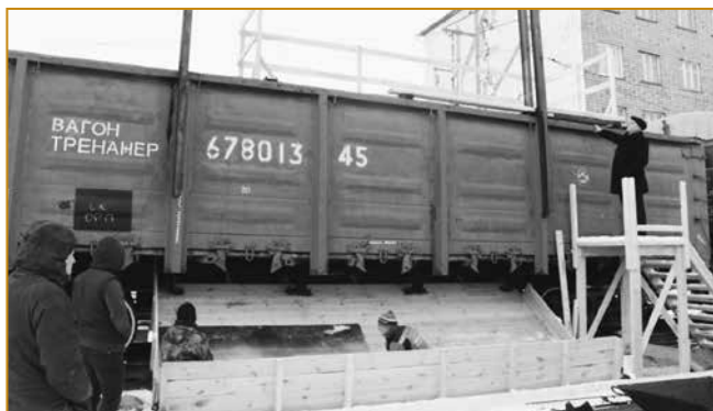
Рис. 3. Механические узлы макета комплекса по очистке вагонов
