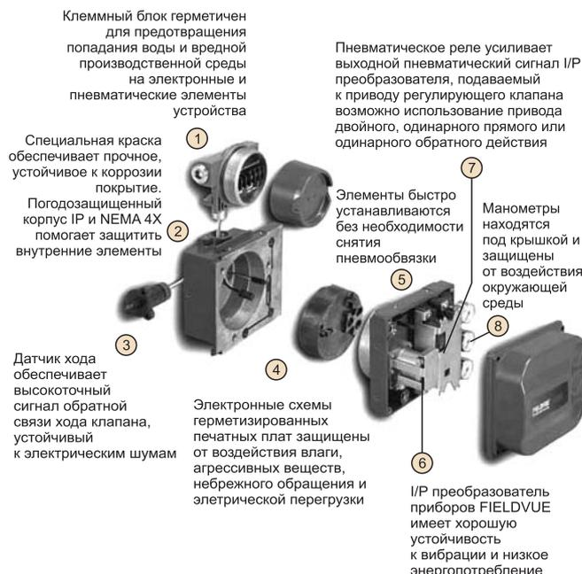
Рис. 2. Конструкция позиционера FIELDVUE DVC, где 1 – клеммный блок, 2 – корпус, 3 – датчик хода, 4 – печатная плата, 5 – основание модуля, 6 – электропневмопреобразователь, 7 – пневматическое реле, 8 – манометры
