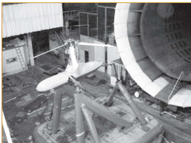
Рис. 1. Испытания крупномасштабной модели несущего винта вертолета в аэродинамической трубе Т-104 ФГУП «ЦАГИ» на винтовом приборе ВП-6
