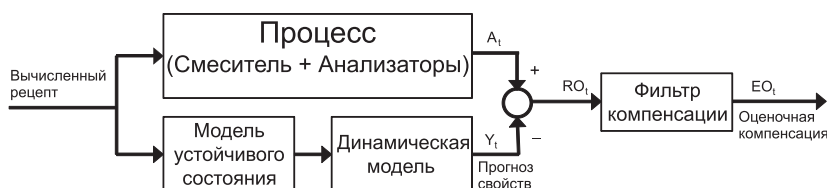
Рис. 5. Коррекция модели смешения по измерениям поточного анализатора, где RO_i – необработанная компенсация, RO_i = A_i - Y_i , EO_i – отфильтрованная оценочная компенсация.
