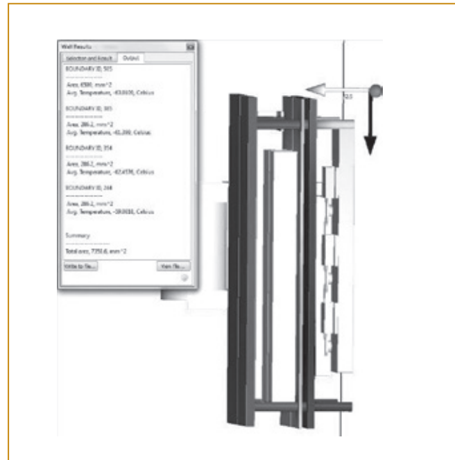
Рис. 4. Распределение температуры по деталям блока управления
