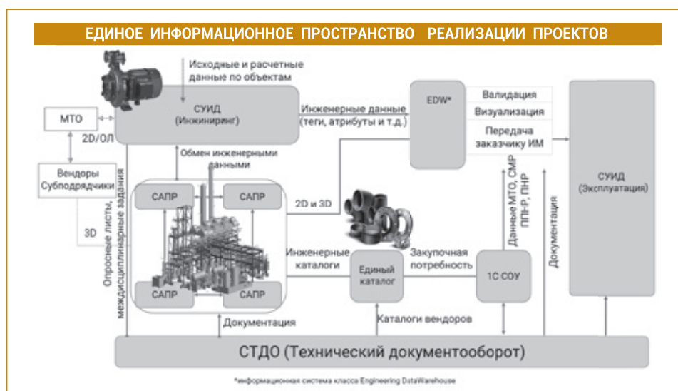
Рис. 3. Элементы системной архитектуры СУИД НИПИГАЗа
