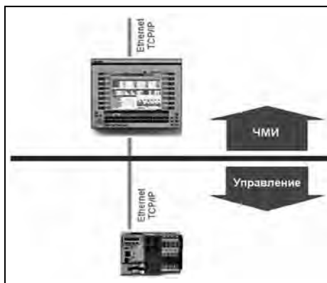
Рис. 2. Распределенная двухкомпьютерная архитектура систем ЧПУ Bosch Rexroth
