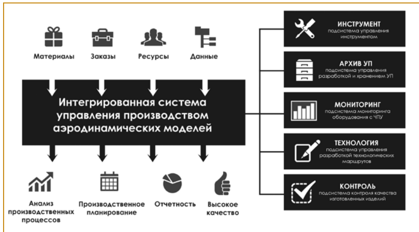
Рис. 3. Состав интегрированной системы управления проектированием и производством аэродинамических моделей ЛА
