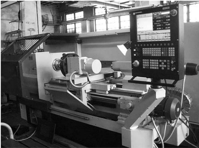
Рис. 9. Токарный станок 16А20Ф3 с СЧПУ IntNC
