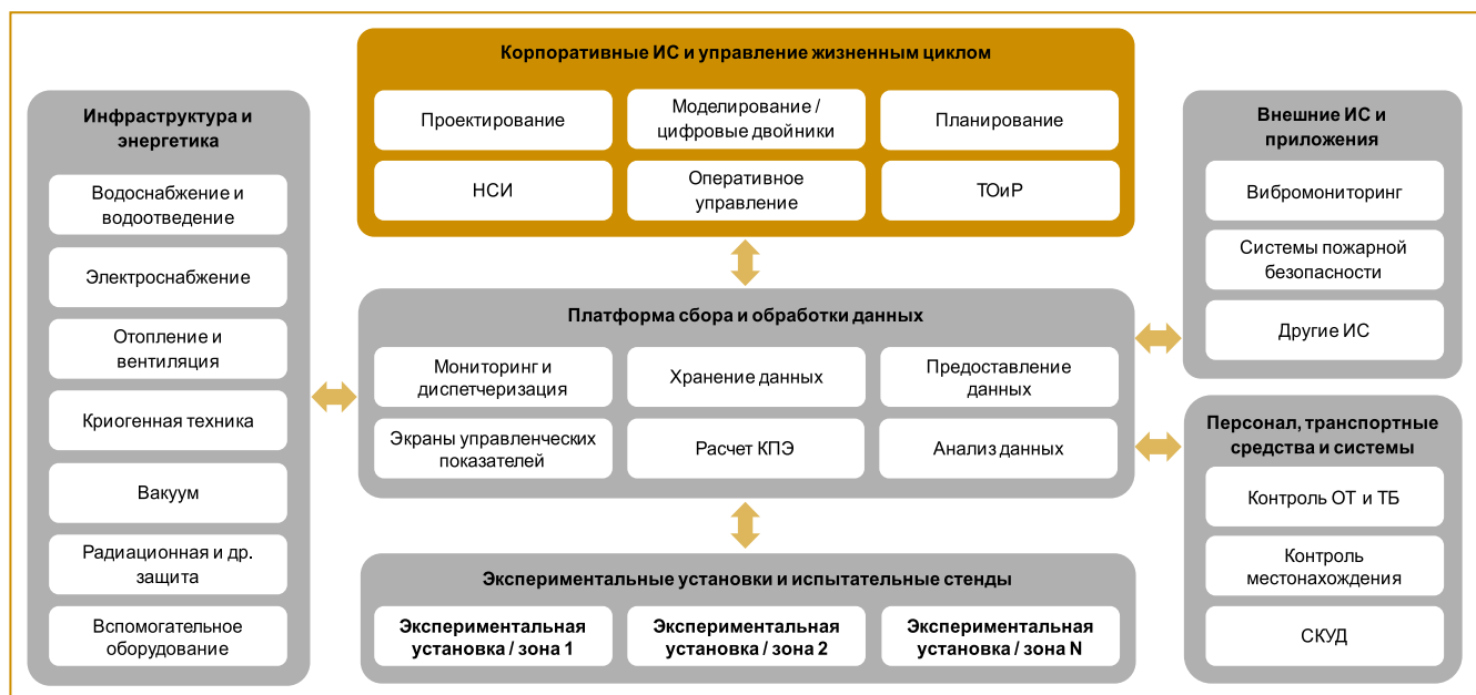
Рис. 1. Обобщенная архитектура информационно-управляющих систем экспериментально-испытательных стендов
