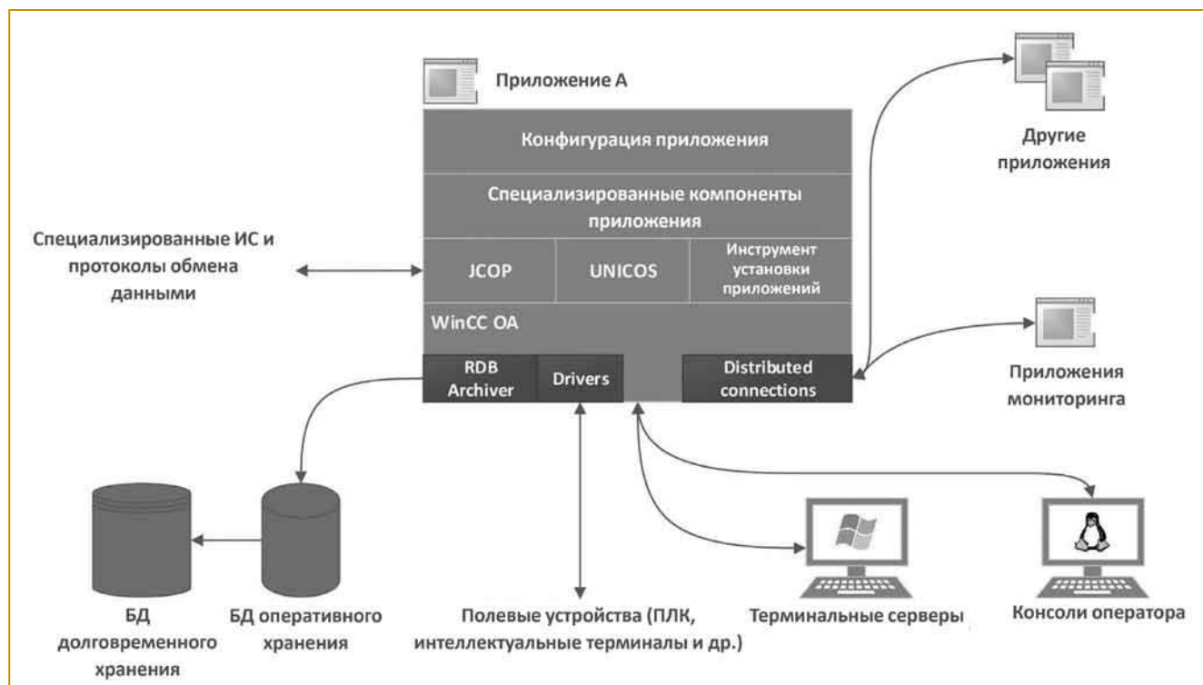
Рис. 4. Структура программного комплекса на базе WinCC OA
