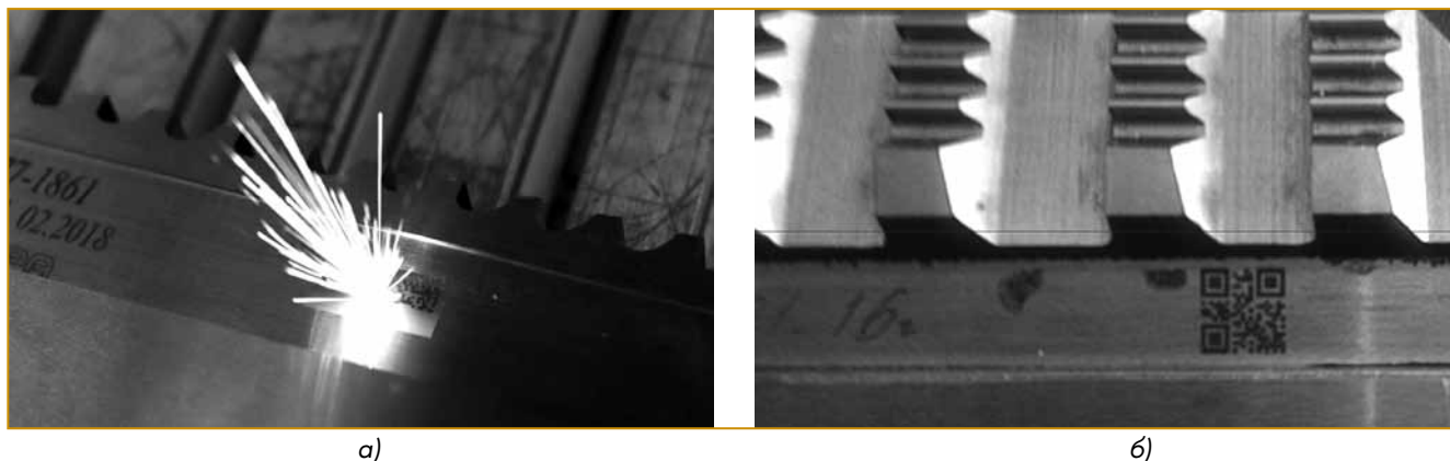
Рис. 4. Фрагмент технологического процесса нанесения ШК и его внешний вид: а) фрагмент процесса маркирования, в) внешний вид ШК на изделии
