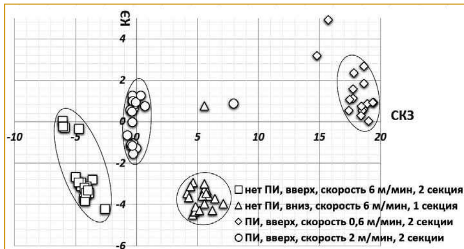
Рис. 4. Пример отображения вибросигналов механизма ЗРШ на плоскости
