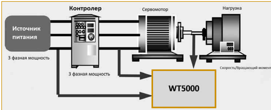
Рис. 2. Схема испытания сервомотора промышленных роботов
