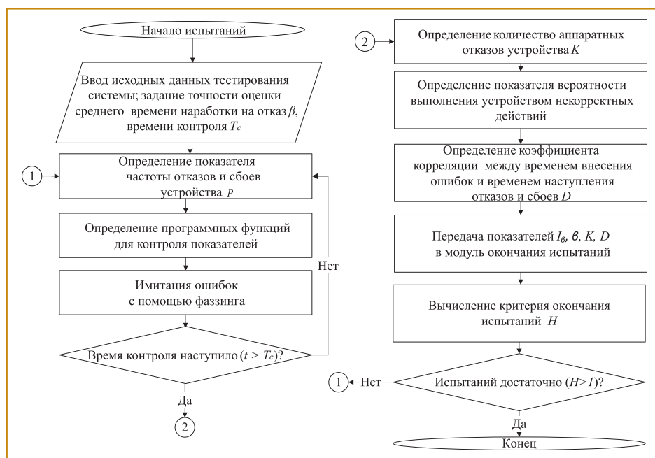
Рис 1. Алгоритм выполнения программы испытаний устройства
