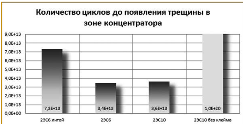
Рис. 8. Число циклов нагружения до начала роста трещины в зоне концентратора
