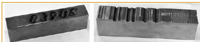
Рис. 6. Вид образца на трехточечный изгиб: слева – образец с концентратором в виде клейма; справа – образец с нанесенным концентратором, повторяющим профиль сечения клейма
