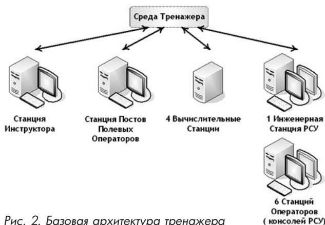
Рис. 2. Базовая архитектура тренажера
