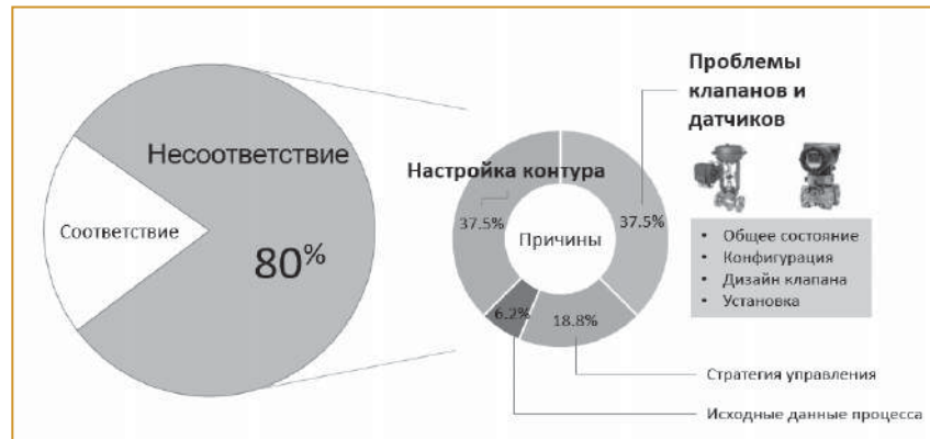
Рис. 5. Основные причины некорректного регулирования. Программный комплекс ISAE разработан таким образом, чтобы выявлять причину и давать персоналу рекомендации по ее устранению
