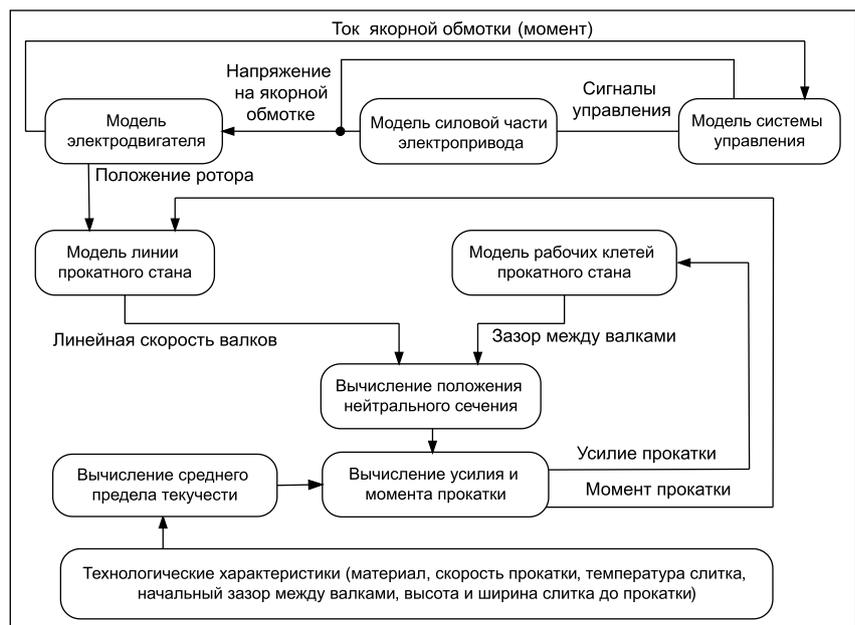
Рис. 1. Функциональная схема моделирования процессов при прокатке
