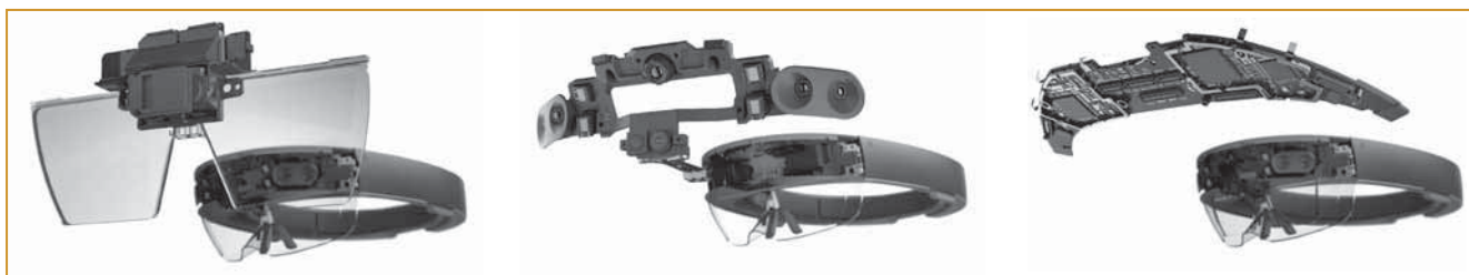
Рис. 2. Очки дополненной реальности Microsoft HoloLens: дисплей, сенсоры, аппаратное обеспечение
