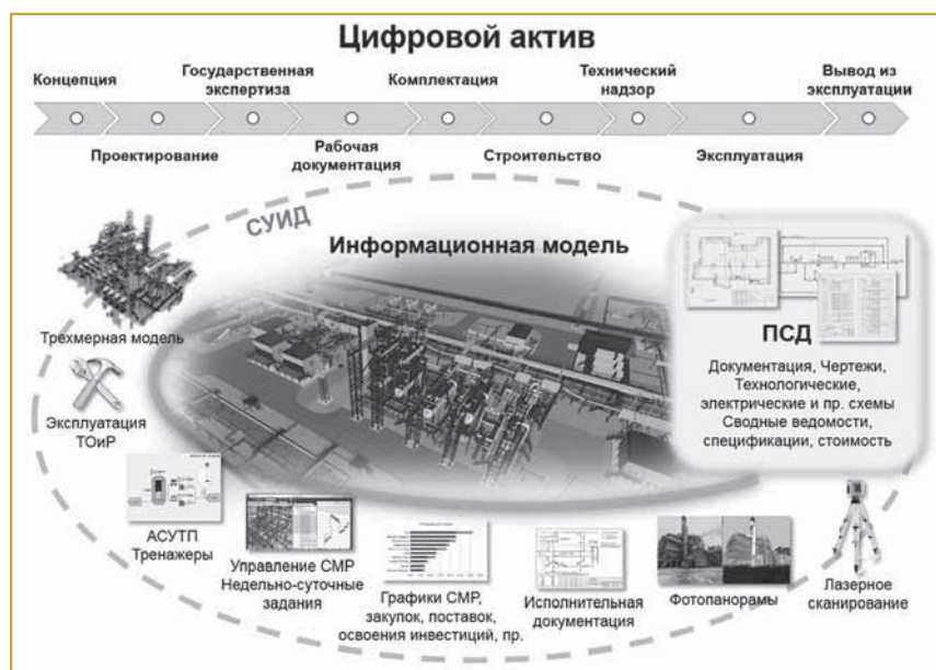
Рис. 3. Схема создания цифрового актива на базе СУИД НЕОСИНТЕЗ и загруженной в нее BIM объекта
