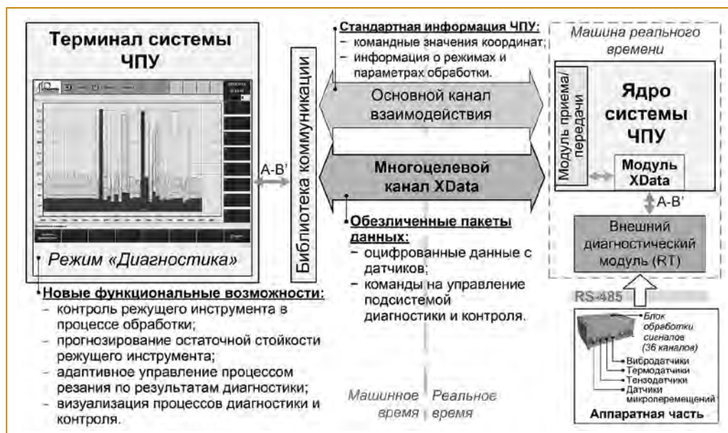
Рис. 4. Структура подсистемы диагностики режущего инструмента, интегрированной в систему ЧПУ «АксиОМА Контроль»
