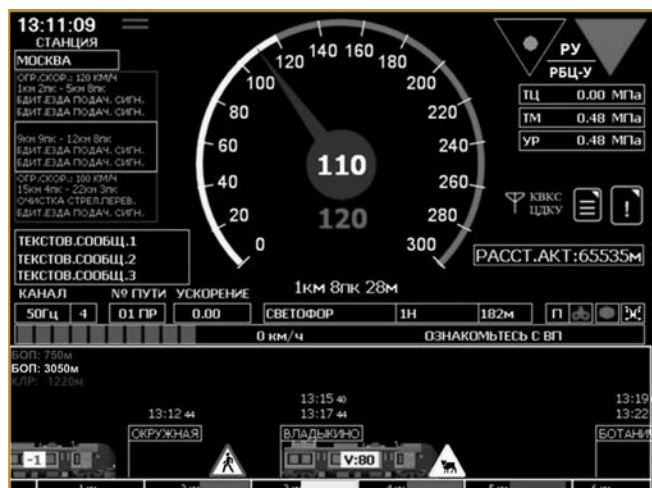
Рис. 2. ЧМИ комплекса БЛОК и БЛОК-М на МЦК для беспилотного движения
