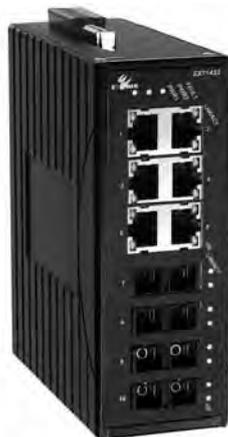
Рис. 2. Промышленный коммутатор Ethernet EX71000 производства EtherWAN. Половина из 8 портов Fast Ethernet и оба порта Gigabit Ethernet могут использовать как медный интерфейс, так и различные типы оптики.
