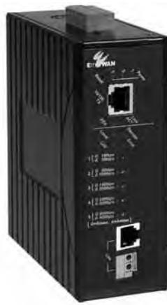
Рис. 1. Удлинитель Ethernet с технологией питания Power-over-Line ED3538T производства компании EtherWAN. Использует технологию Ethernet-over-VDSL для передачи трафика со скоростью до 100 Мбит/с на расстояние до 2 км. Вместе с сигналом передает до 30 Вт мощности для питания конечного устройства. Тип кабеля – витая пара или телефонный кабель.
