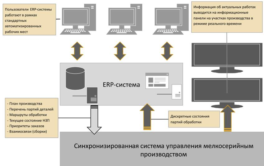
Рис. 4. Схема автоматизации системы
