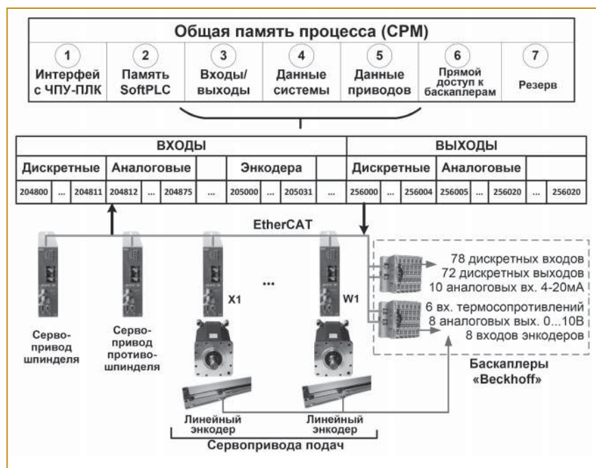
Рис. 3. Структура разделяемой памяти процесса системы управления обрабатывающим центром наклонной компоновки
