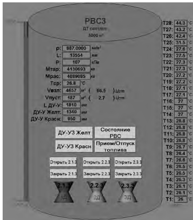
Рис.6. Мнемосхема отдельного PBC
