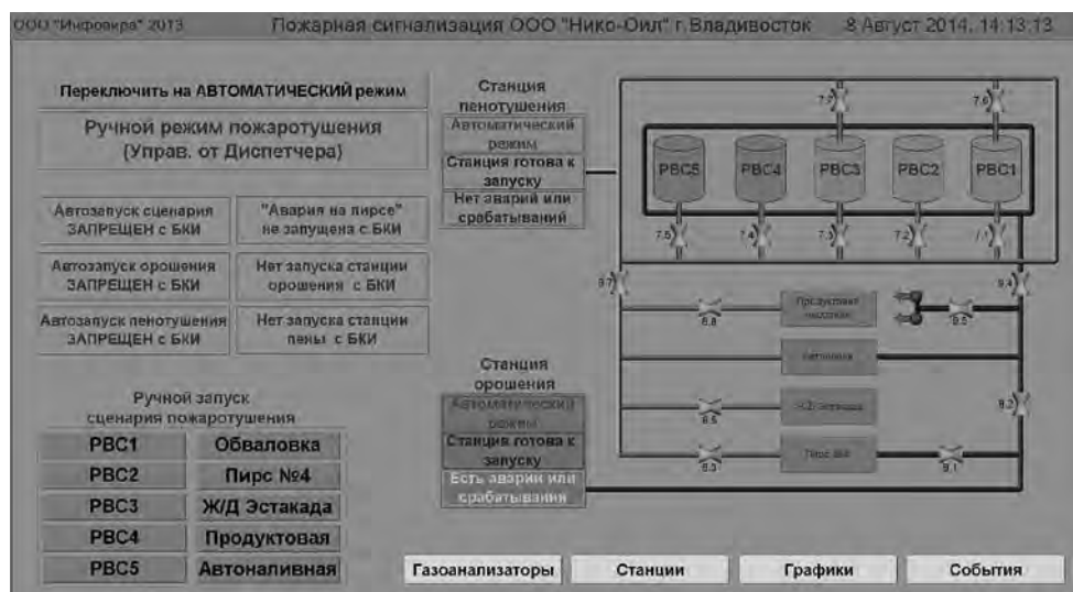
Рис. 10. Мнемосхема контроля и управления подсистемой пожаротушения
