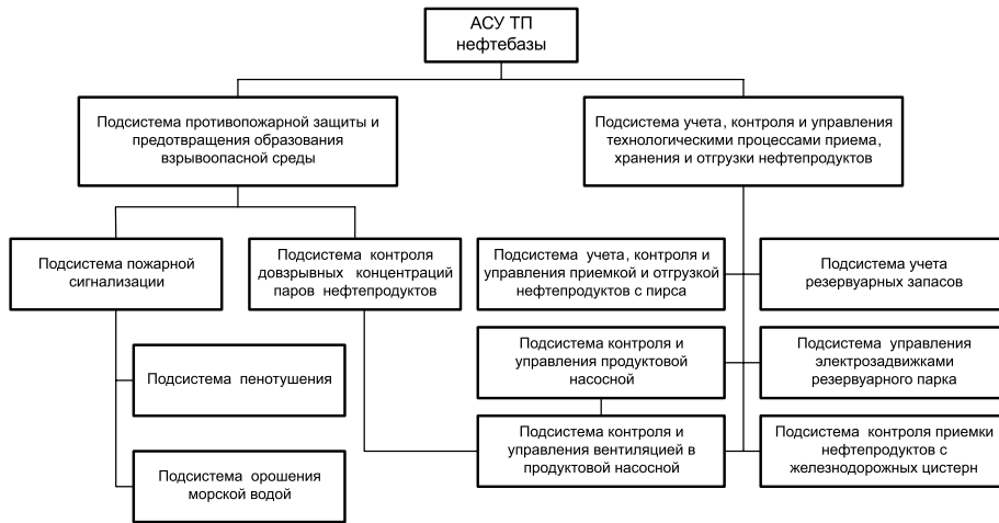
Рис. 1. Структурная схема иерархии построения АСУТП нефтебазы
