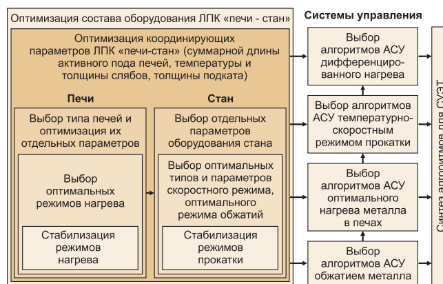
Рис. 2. Реконструктивные мероприятия и алгоритмы управления для оптимизации технико-экономических показателей широкополосных прокатных станов
