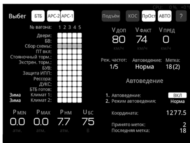
Рис. 3. Экран монитора машиниста системы автоведения
