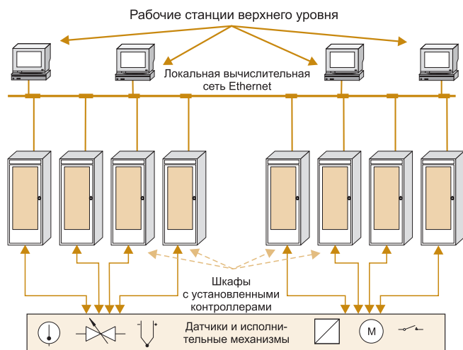
Рис. 1. Обобщенная структура АСУТП на базе средств комплекса "ПАССАТ"
