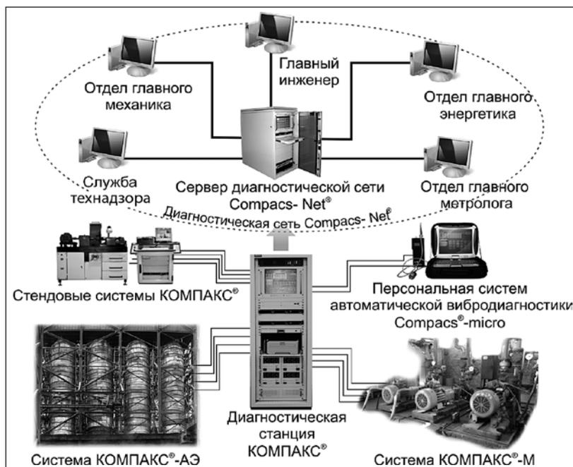
Рис. 1. Структурная схема эксплуатации оборудования по техническому состоянию на основе технологии АСУ БЭР™ КОМПАКС®
