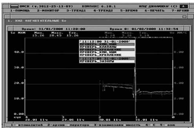
Рис. 5. Экран «ТРЕНД» диагностических признаков с выводом сообщений экспертной системы поддержки принятия решений
