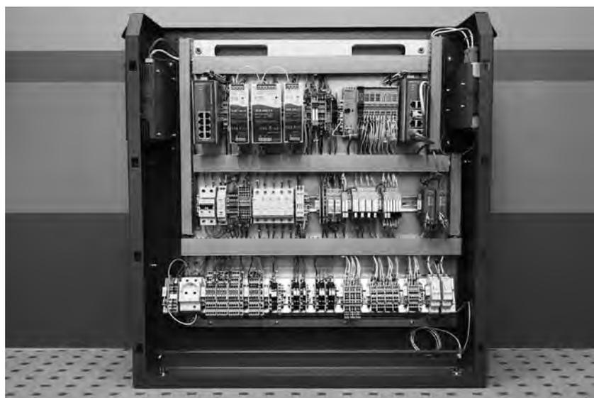
Рис. 5. Контроллер полосы на базе ПЛК Phoenix Contact ILC 130 с портом Ethernet
