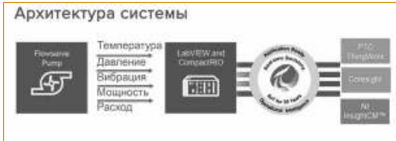
Рис.8. Архитектура системы мониторинга водяных насосов
