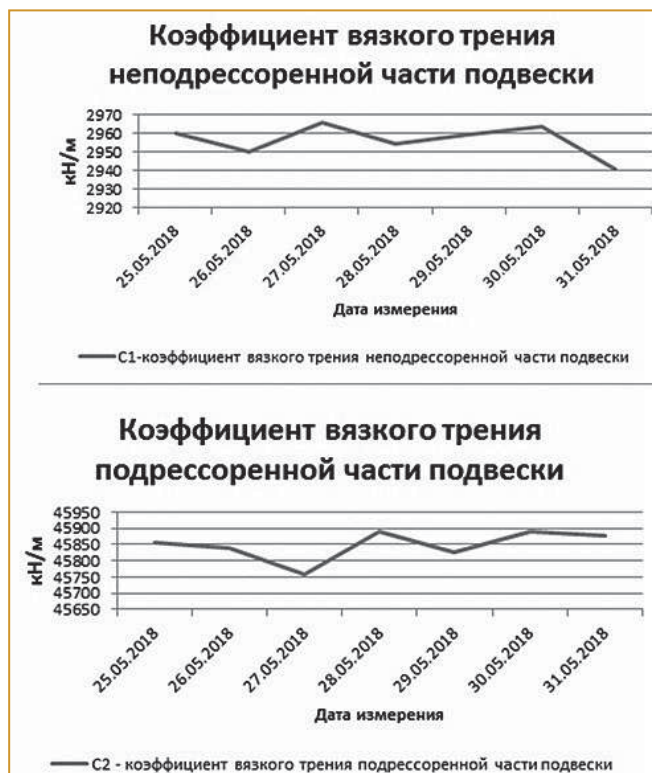
Рис. 9. Результаты мониторинга параметров подвески автомобиля
