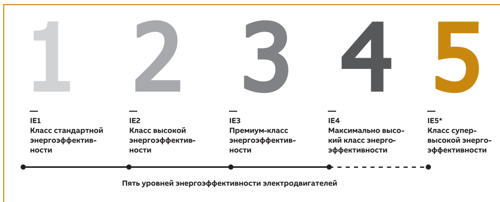
Рис. 1. Шкала оценивания энергоэффективности электродвигателей
