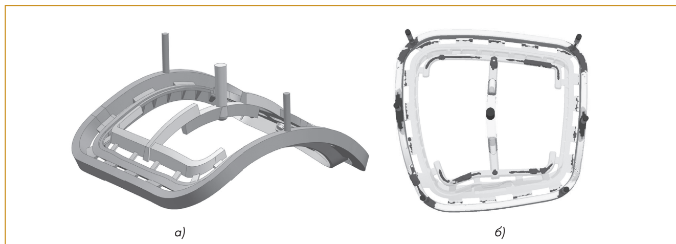
Рис. 2. Новая конструкция ЛПС для отливки типа «Рама»: а) 3D-модель литейного блока; б) результат прогноза пористости
