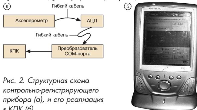
Рис. 2. Структурная схема контрольно-регистрирующего прибора (а), и его реализация в КПК (б)
