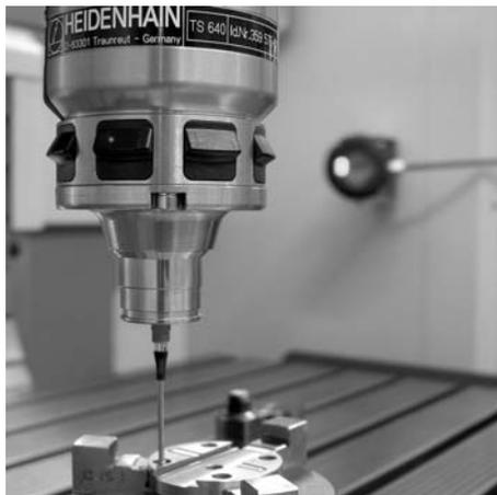
Рис. 10. Обмер детали при помощи измерительного щупа типа TS
