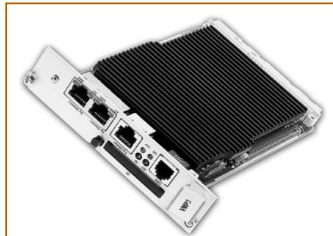
Рис. 1. Плата VMP3 компании Kontron как пример современного продукта на базе технологии VME. Модуль оснащен процессором Freescale MPC8541 PowerPC с тактовой частотой 660 МГц, несет до 256 Мбайт памяти DDR-SDRAM с поддержкой коррекции ошибок, имеет два интерфейса Gigabit Ethernet, порт Fast Ethernet и гнездо CompactFlash (опционально). Изделие VMP3 работает при температурах -40...85°C и потребляет около 10 Вт
