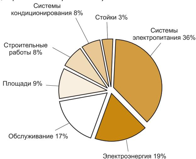
Рис. 2. Распределение составляющих ПСВ для типичной стойки в компьютерном центре повышенной готовности (с резервированием 2N)
