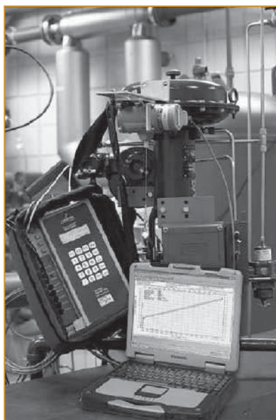
Рис. 3. Мобильный диагностический комплекс FlowScanner 6000 Valve Diagnostic System
